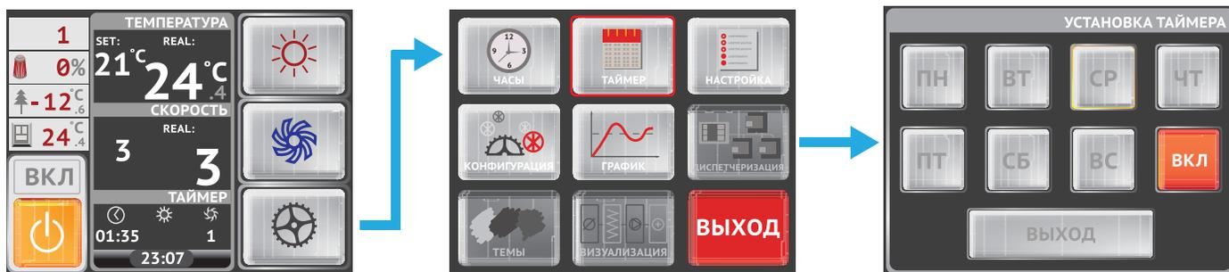
Кнопка «ВКЛ/ВЫКЛ» включает/выключает режим работы по таймеру. Нажатие на кнопку дня недели вызывает переход в подменю установки таймеров для этого дня недели.
